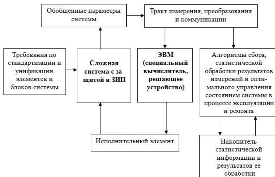
Рис. 2 Структурная схема автоматической эксплуатации сложного технического объекта
