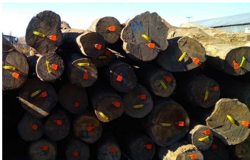
Рис. 1 Маркировка древесины при помощи RFID меток
