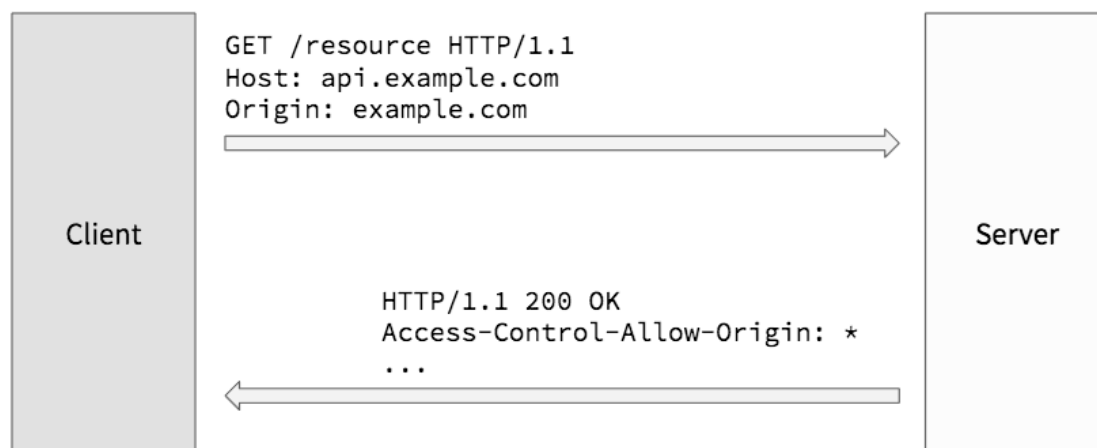
Рис. 1 Simple request. Звёздочка означает, что допускается запрос с любого домена.
